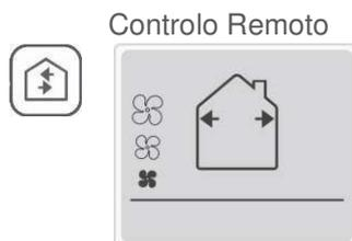
Ao pressionar o botão de função específica, todas as unidades funcionarão constantemente em extração com a possibilidade de alterar a velocidade conforme necessário.
