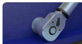
5. Execute o aperto final usando uma chave Dinamométrica
